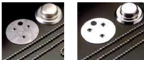
処理前 処理後 図-7 SUS304 部品の化学研磨処理
